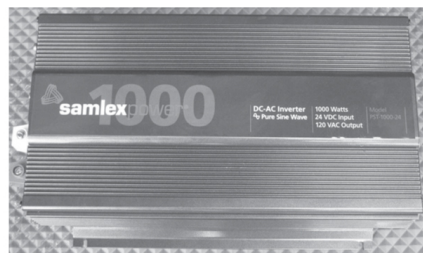
Samlex 24 volt DC to 120 volt AC inverter
